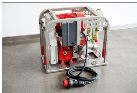
Stromzufuhr über einen explosionsgeschützten Stecker
