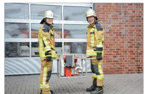
tragbar durch kompakte Leichtbauweise – Einsatz an schwer zugänglichen Orten
