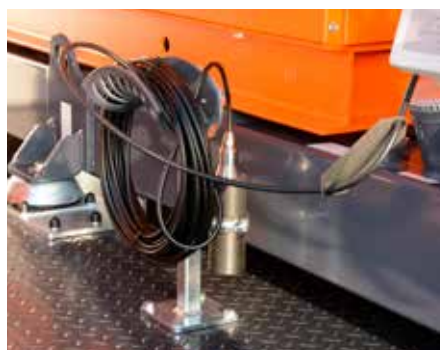
Automatikbetrieb über Höhenstandsonde
